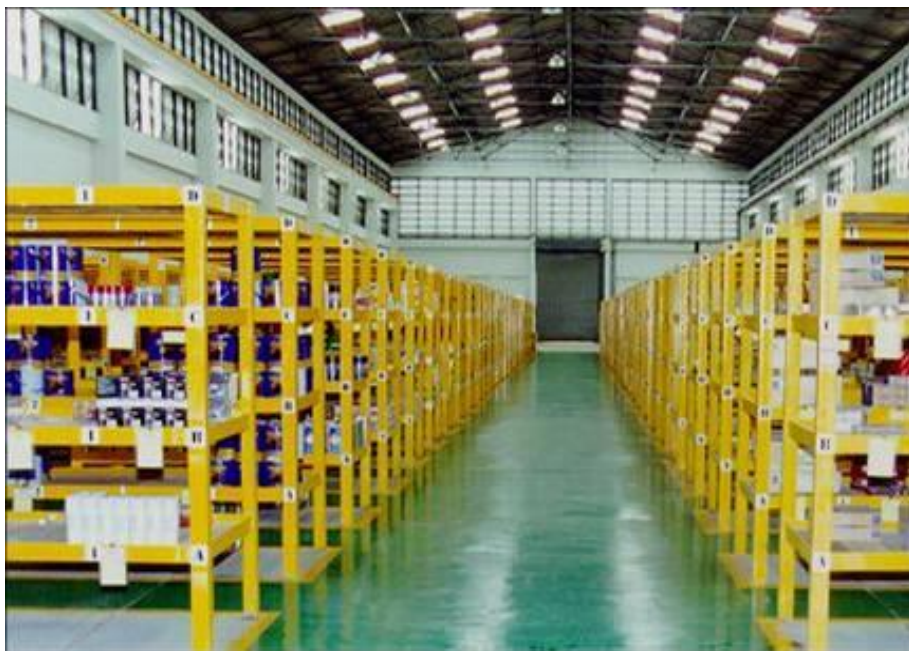
Hình 39: Bố trí trong kho - sử dụng sơ đồ lưới
