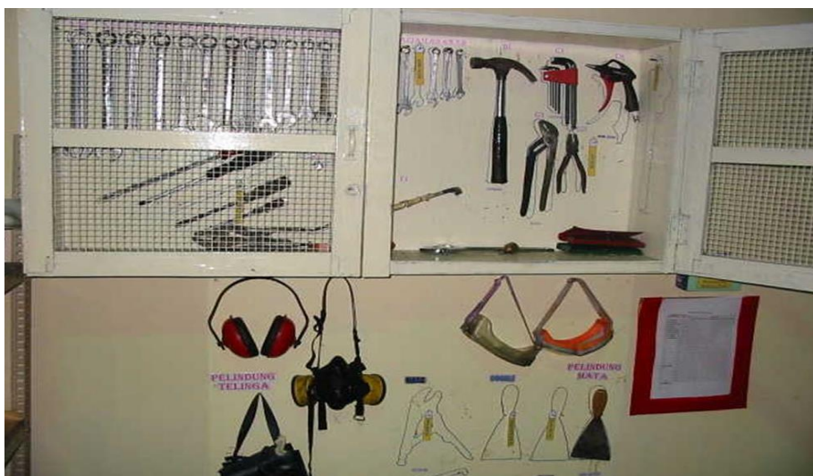
Hình 63: Tủ dụng cụ trong xưởng - vị trí để dụng cụ được qui định bằng hình vẽ tại vị trí đó
